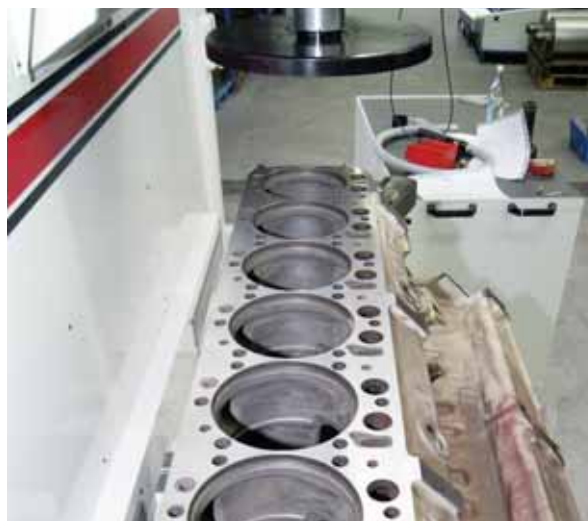
После поперечной обточки уплотняющая поверхность – как новая.
