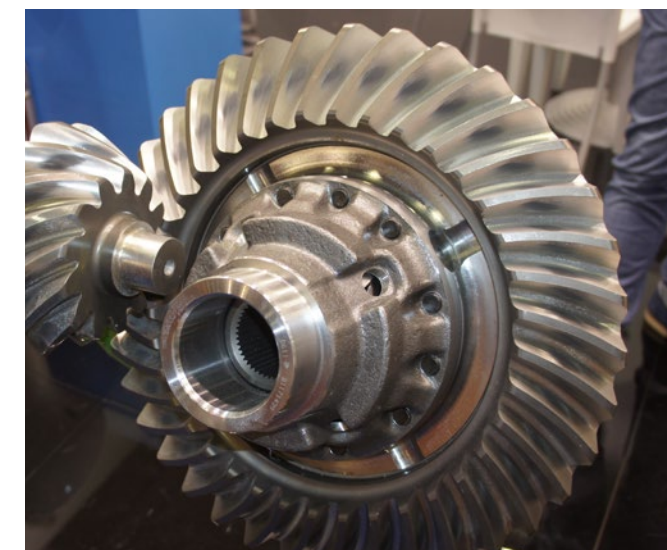
Главная передача – эти шестерни имеют повышенный ресурс. И вообще красиво сделано...
