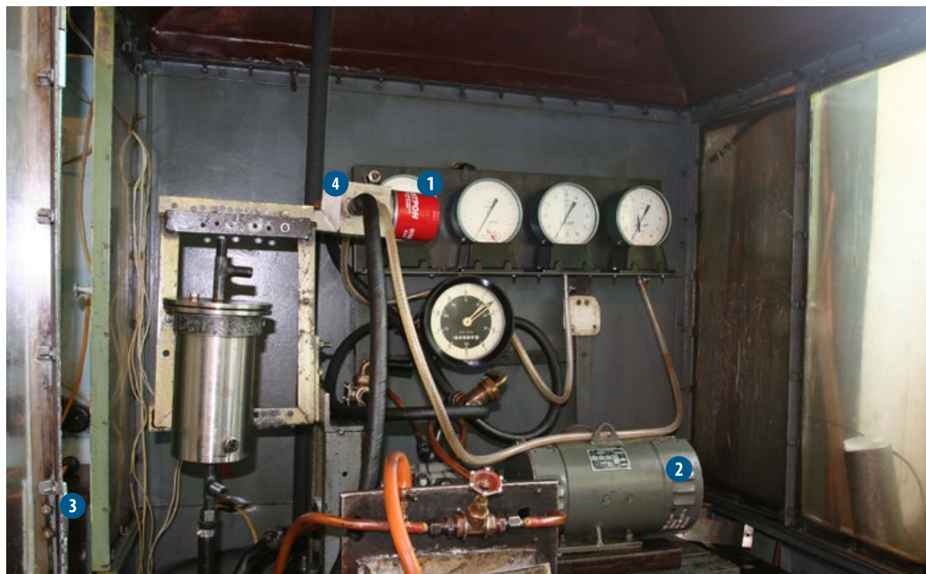
Стенд для определения гидравлических характеристик, тонкости и полноты отсева масляного фильтра: 1 – проверяемый фильтр; 2 – электродвигатель для привода масляного насоса; 3 – масляный насос (расположен за щитом), соединенный с масляной ванной; 4 – проставка с калиброванными каналами, выполненная по требованиям ISO 4548. Она позволяет однозначно трактовать гидравлические характеристики испытуемого изделия
