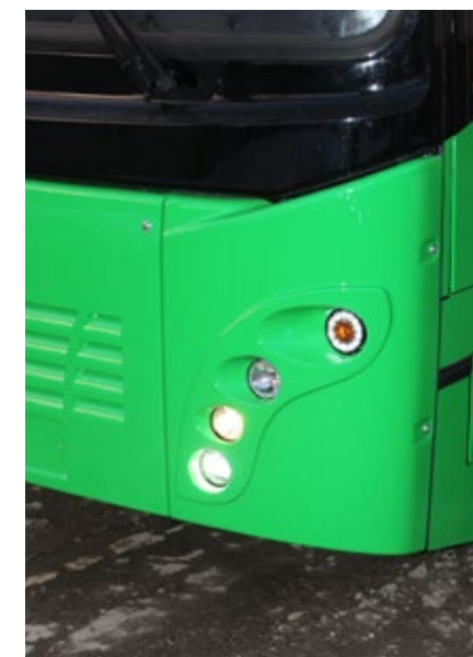
В боковых пластиковых легкоъемных панелях размещены интегральные фары, поворотники, фонари ближнего света и габаритные огни
