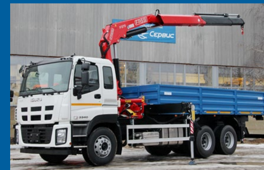
Крано-манипуляторная установка «Чайка-Fassi» на шасси HINO
