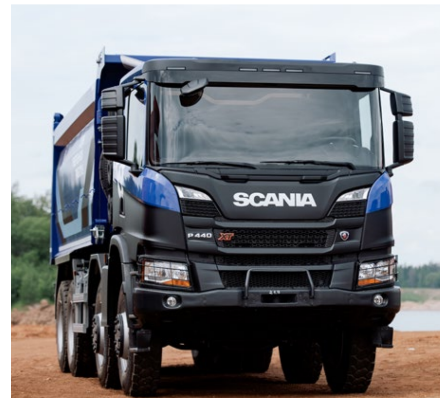
Индекс ХТ означает грузовик для тяжелых условий. Может быть полноприводным. Для горных работ, строительства, лесозаготовки, для Севера в частности и грунтовых дорог вообще.
